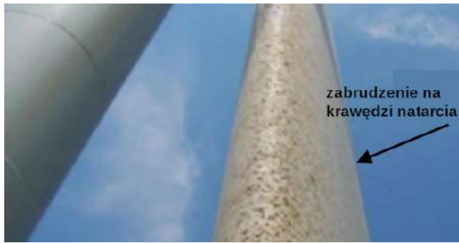
Rysunek 5. Wpływ zabrudzeń na pracę turbin wiatrowych
